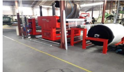
La M903 está equipada con convertidor de frecuencia para la regulación de la velocidad del bondeo, lo que permite un proceso controlado, rápido y muy tranquilo.
