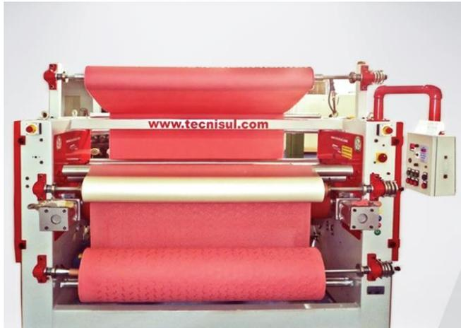
Está equipada con convertidor de frecuencia para la regulación de la velocidad del bondeo, lo que permite un proceso rápido, controlado, rápido y muy tranquilo.
